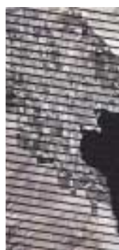
Obr. 3. Porucha skenovacího zrcátka družice Landsat 7.
