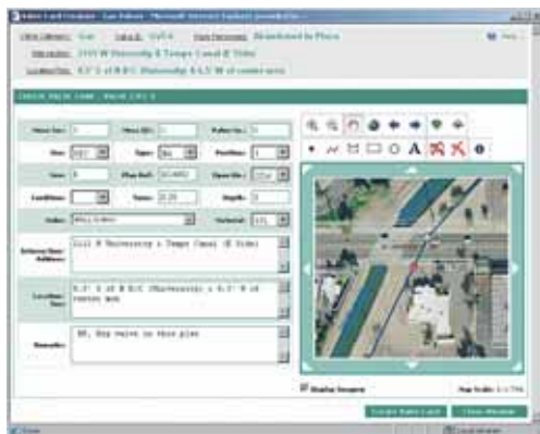
Pomocí ArcGIS Serveru mohou pracovníci v terénu mapovat rozmístění plynových ventilů a sledovat stav zařízení.
